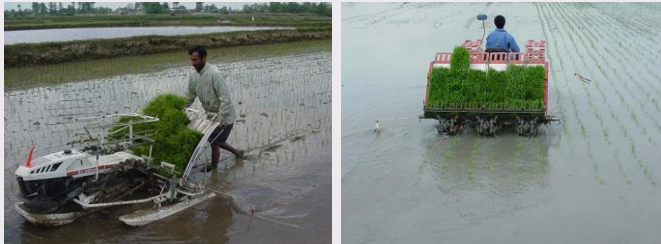
شکل ۱۰- نشاکاری مکانیزه با ماشین نشاکار راه رونده ۴ ردیفه (راست) و سوار شونده ۶ ردیفه (چپ)
